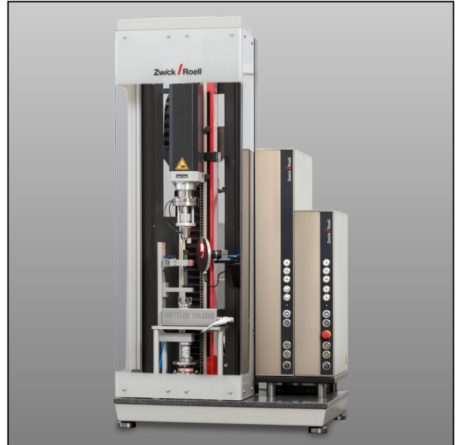
Anwendungsbeispiel: Prüfung eines Insulin-Pens
