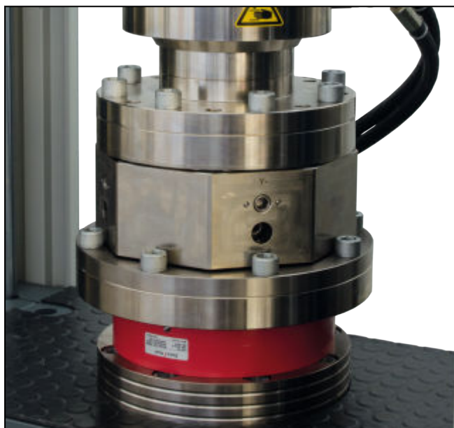
Ausrichteinheit Fmax 250 kN über Flansch zwischen Kraftaufnehmer und Probenhalter montiert
