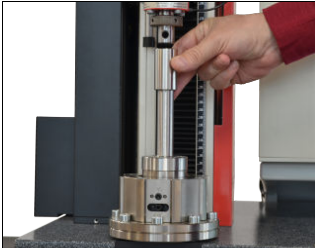
Ausrichteinheit für Achsenversatz- und Winkelkorrektur mit Justagestab, Fmax 5 kN
