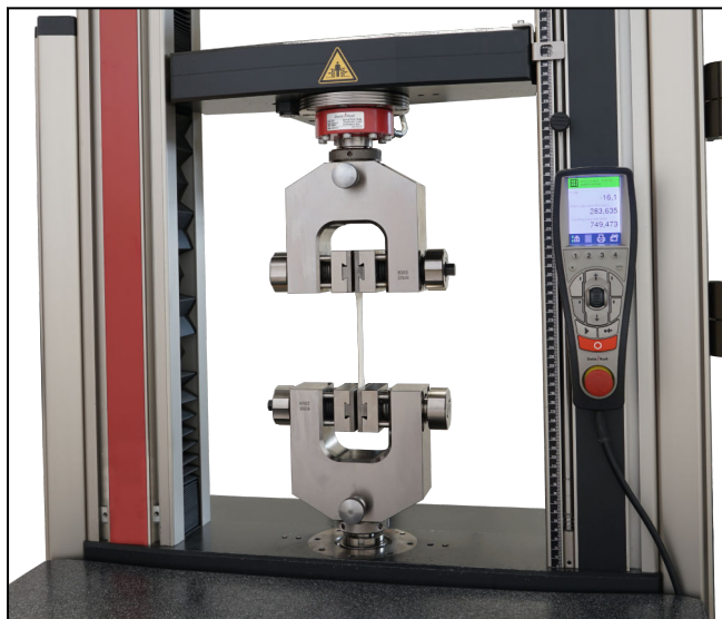
Schraub-Probenhalter Typ 8355, Fmax 20 kN
